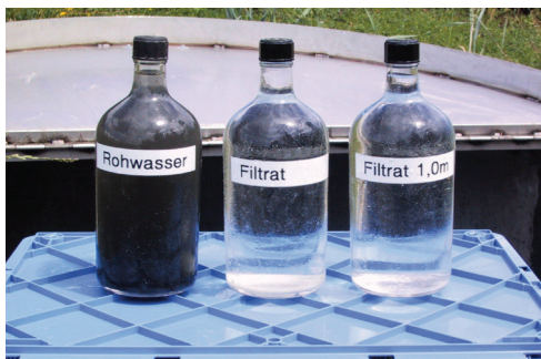
Strassenabwasser unbehandelt und nach Durchlaufen eines Sandfilters
